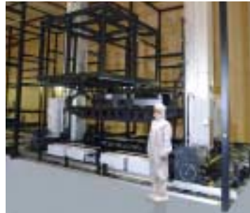
クリーンルーム用保管システム 「クリーンストッカー」/ 液晶業界
