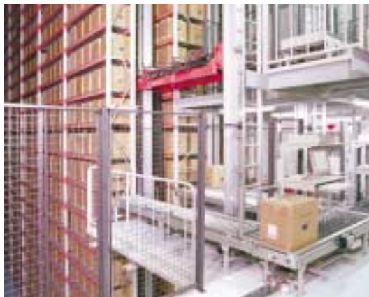
ケース自動倉庫「ファインストッカー」/ 医療用ウェア業界
