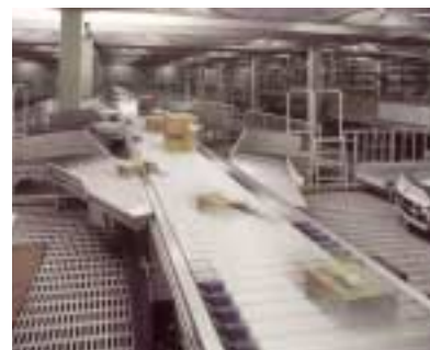
自動仕分け装置「ジェットサーフィンソーター」/ 3PL業界
