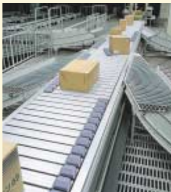
高速自動仕分けシステム 「ジェットサーフィンソーター」/3PL業界
