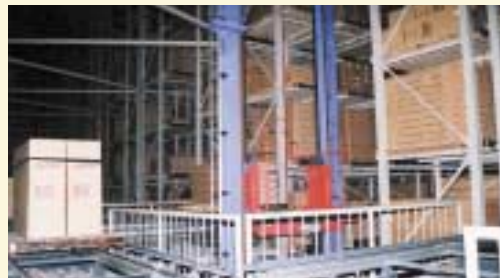
台升家具納入の自動倉庫(奥行き300mは世界最大級) / 中国
