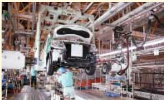
フリクション搬送システム「フレキシブルドライブシステム」/自動車業界
